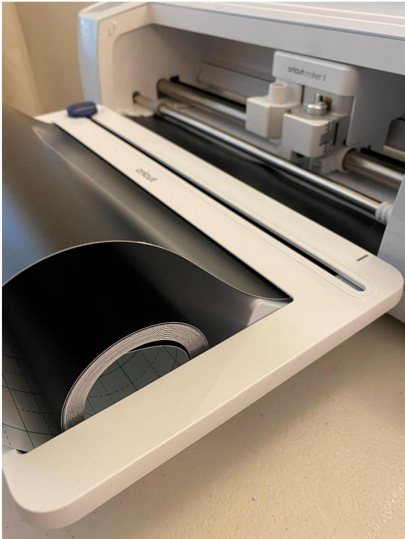
**Tipp:** Stell bitte sicher, dass die Papierschneiderklinge auf beiden Seiten am Papierschneiderschlitz eingesetzt ist, sodass diese beim Einführen des Materials nicht im Weg ist.
