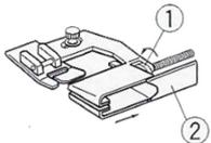
Drehen Sie das Rädchen (1) und stellen Sie den Bandeinfassschieber (2) so ein, dass das Band gut durch läuft.
