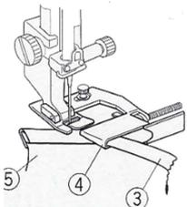
Führen Sie das Band (3) in die Führung (4) ein.
