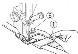
Stellen Sie die Führung Nut mit der Schraube (6) ein. Führen Sie, den Stoff mit der linken Hand und das Band (3) mit der rechten Hand beim nähen.
